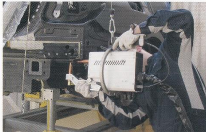
二次ケーブルが無いため、作業性が向上
