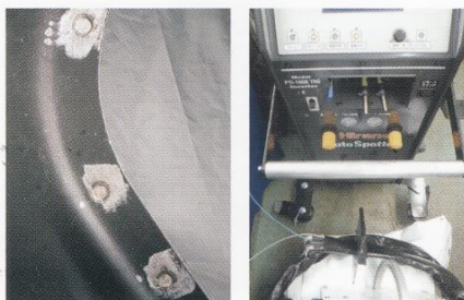
トランス内蔵のエアガンにより、省電力でも高い溶接能力を発揮 ガンケーブルを容易に取り外すことが可能で、メンテナンスが楽にできる
